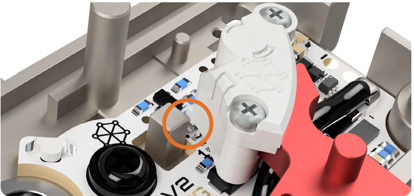
De magneethouder moet tegen de contactstop rusten
